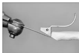
Falsch! Das Sägeblatt wird nicht korrekt an der Föhrung entlang geföhrt!
